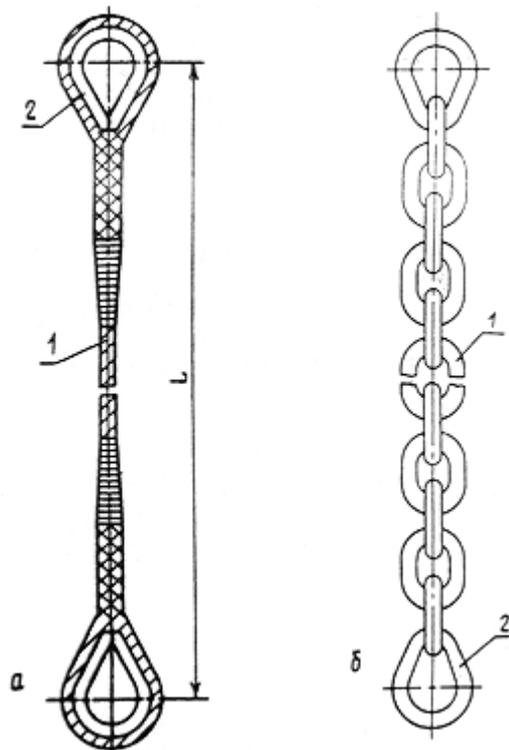
Рис. П.1.1. Канатная (а) и цепная (б) ветви стропа:
