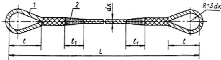
Рис. П.1.25. Универсальный строп, исполнение 1:
