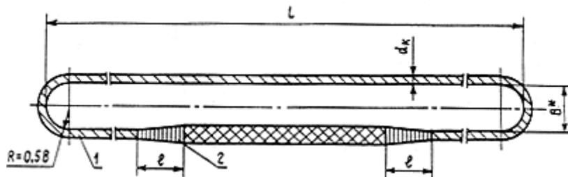
Рис. п.1.26. Универсальный строп, исполнение 2:
