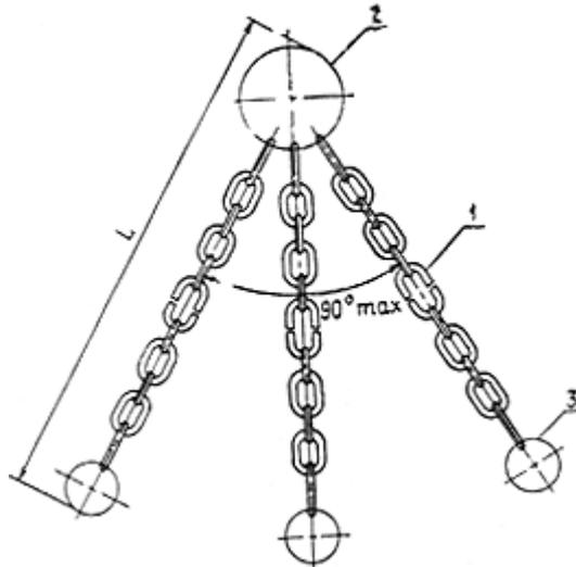
Рис. П.1.29. Трехветвевая строп:
