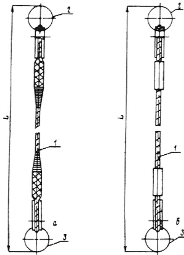
Рис. П.1.21. Одноветвевой строп (а - заделка концов каната заплеткой, б - опрессовкой алюминиевой втулкой):
